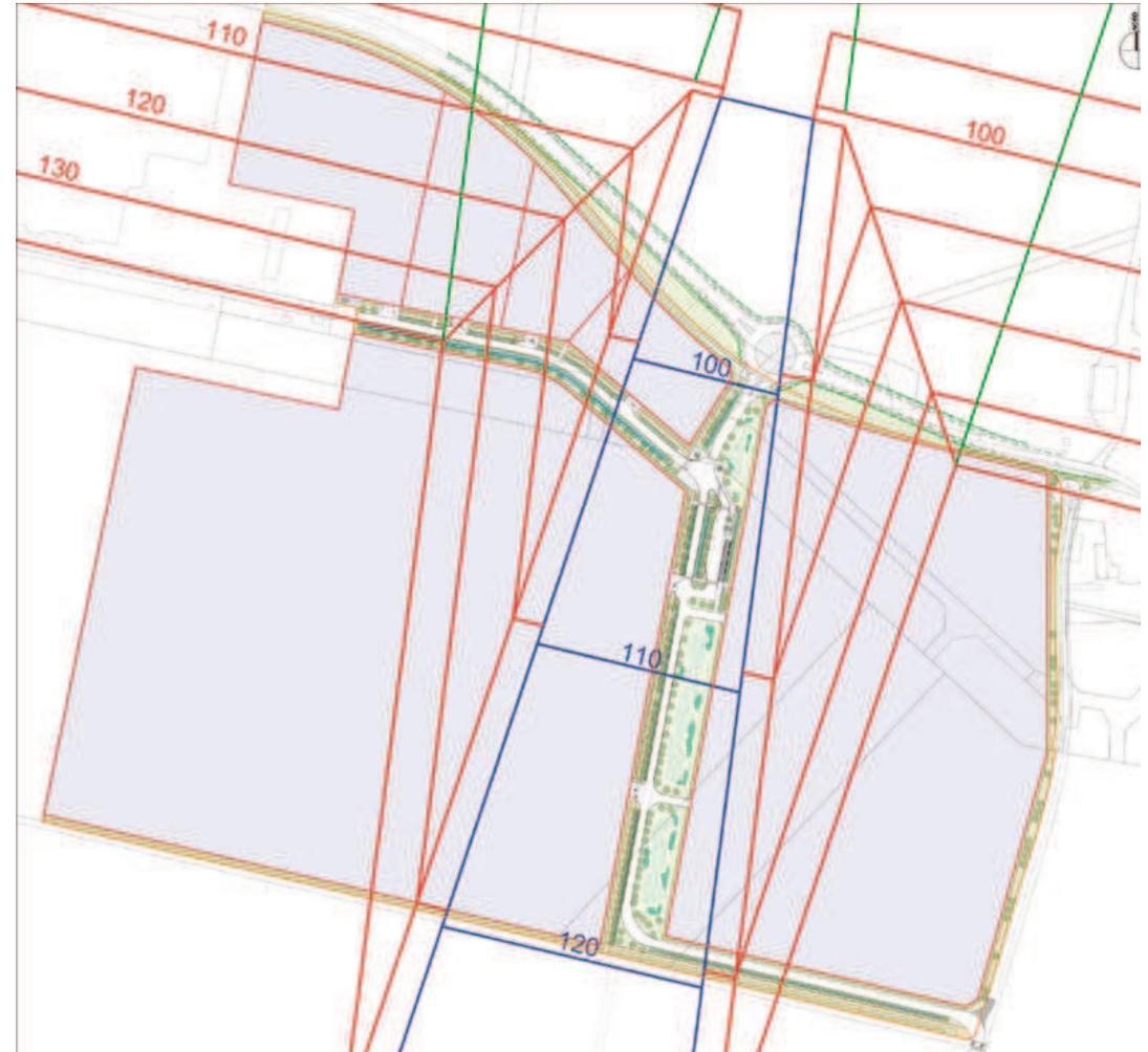
Schéma de superposition des servitudes aéronautiques avec le projet AVP
