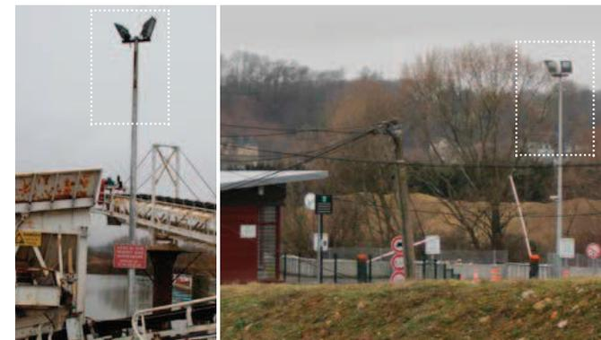
*Exemples à ne pas suivre: l'orientation des projecteurs est mauvaise, elle induit une déperdition de lumière vers le ciel trop importante*
