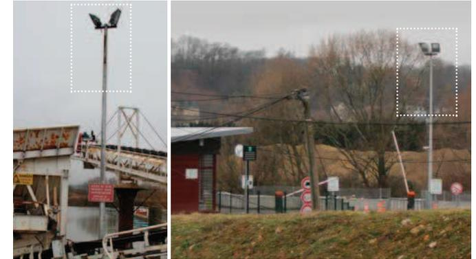
*Exemples à ne pas suivre: l'orientation des projecteurs est mauvaise, elle induit une déperdition de lumière vers le ciel trop importante*
